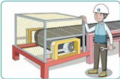
1 원동기, 회전축 등에 덮개, 울 등 설치
